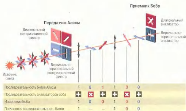
Схема устройства для квантового распространения ключа (Zbinden H., Bchmann-Pasquinnucci H., Gisin N., Ribordy G. Quantum cryptography // Appl. Phys. 1998. В 67. P 743 — 748)
